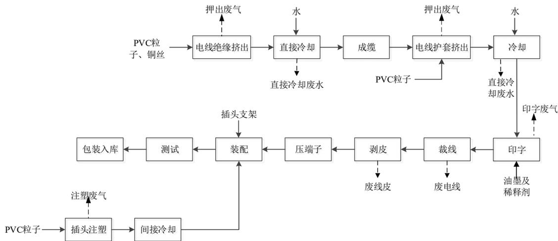
图 2-3 聚氯乙烯绝缘软电缆电线及电源插头生产工艺流程图
