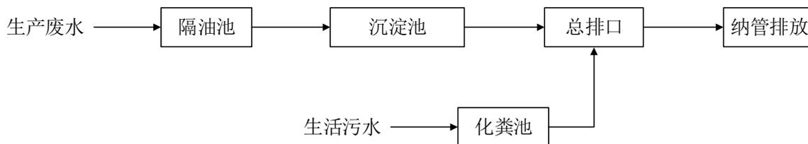
图 4-2 项目废水处理工艺流程
