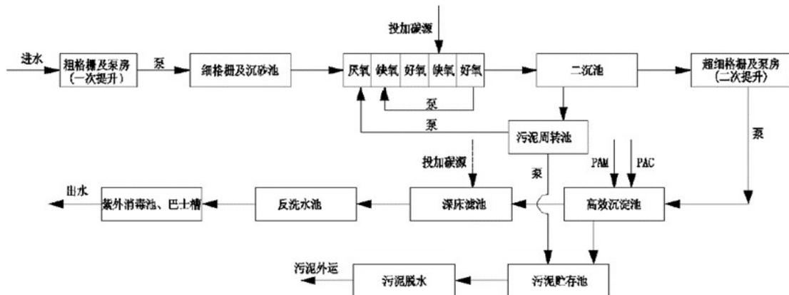
图 4-4 二期污水处理工艺流程图
