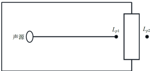
图4-4 室内声源等效为室外声源图例
