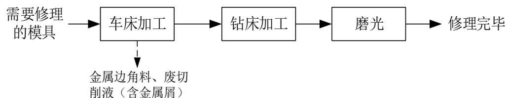
图 2-3 模具修理工艺流程图
