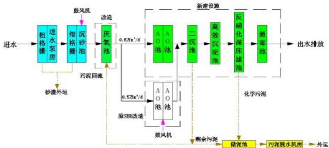
图 4-1 污水处理工艺流程图
