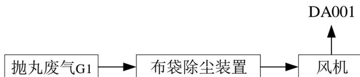
**图 4-3 项目废气处理工艺流程图**
