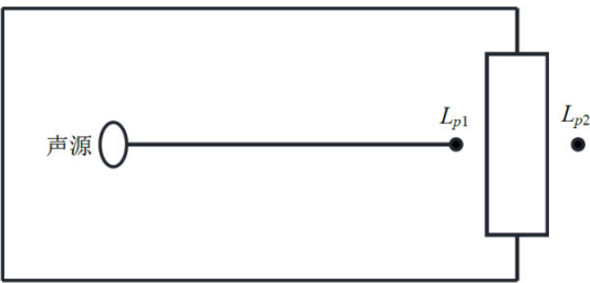
图4-4 室内声源等效为室外声源图例
