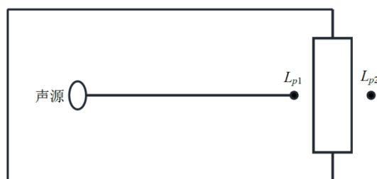
图4-6 室内声源等效为室外声源图例
