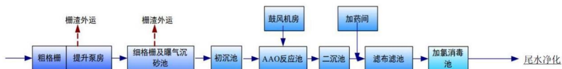
图 4-3 现状污水处理工艺流程图
