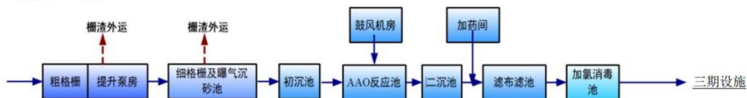
图 4-3 现状污水处理工艺流程图
