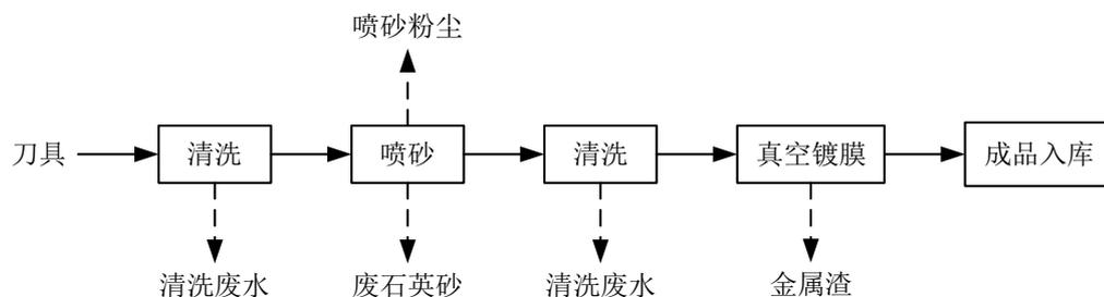
图2-2 项目真空镀膜加工工艺及产污环节图
