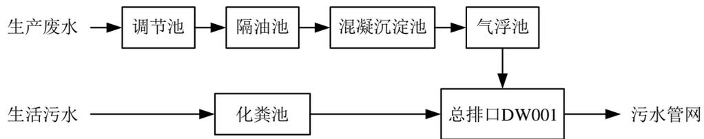
图4-2 废水处理工艺流程图
