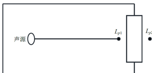
图4-5 室内声源等效为室外声源图例
