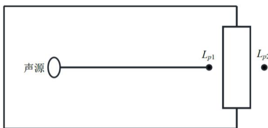
图 4-5 室内声源等效为室外声源图例
