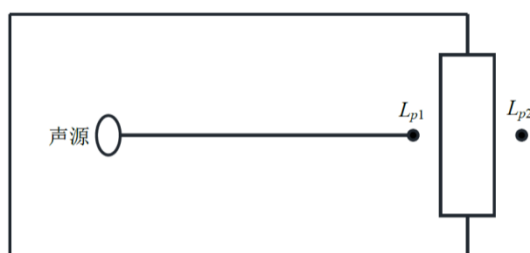
图4-4 室内声源等效为室外声源图例
