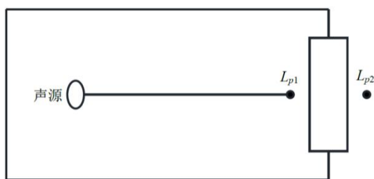
图 4-5 室内声源等效为室外声源图例
