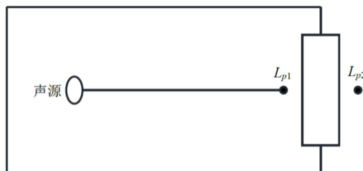
图4-5 室内声源等效为室外声源图例
