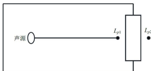
图 4-6 室内声源等效为室外声源图例
