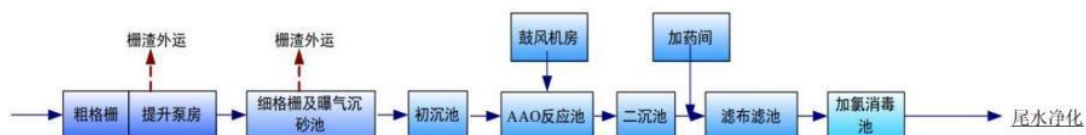
图 4-3 现有工程污水处理工艺流程示意图
