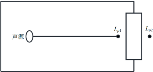
图 4-5 室内声源等效为室外声源图例
