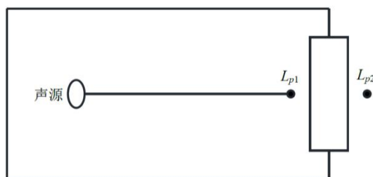
图 4-6 室内声源等效为室外声源图例
