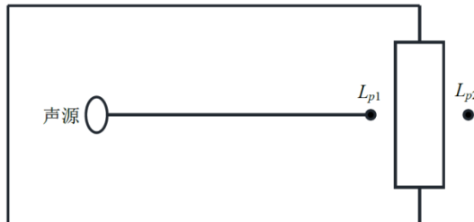
图 4-3 室内声源等效为室外声源图例
