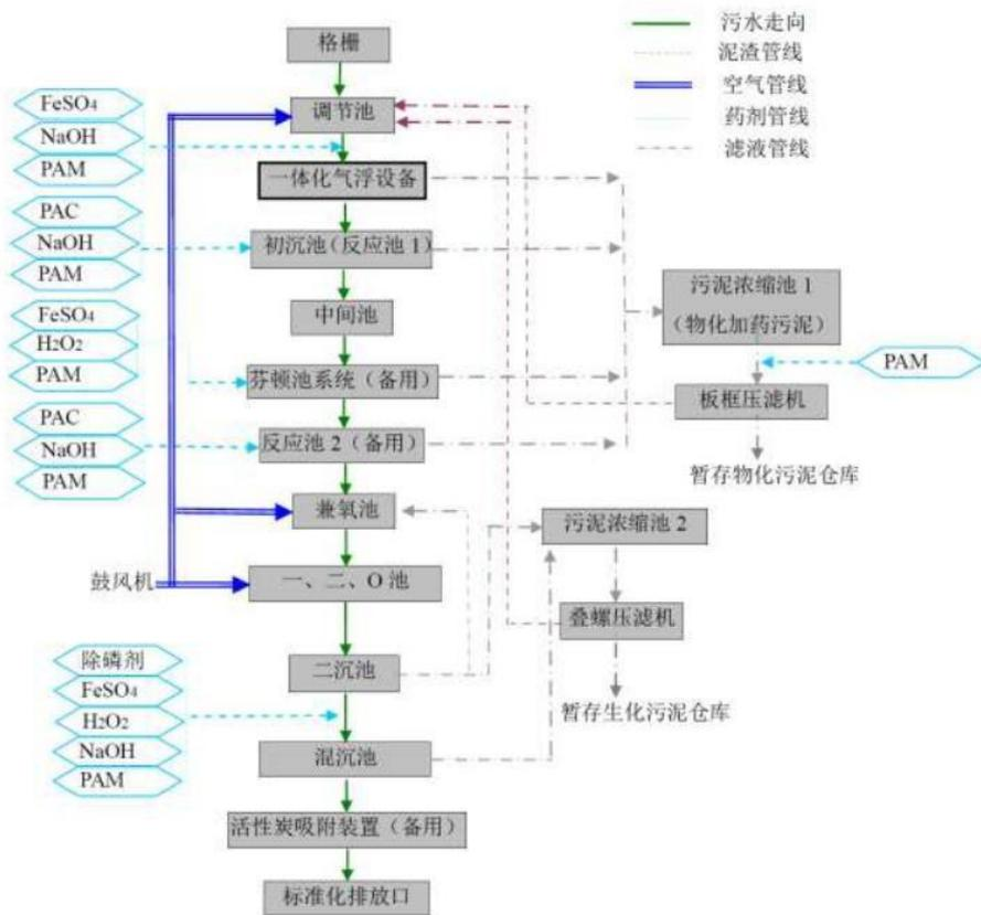
图 4-3 污水处理工艺流程图
