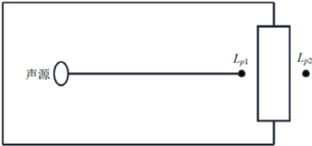
图 4-9 室内声源等效为室外声源图例
