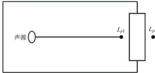
图 4-7 室内声源等效为室外声源图例
