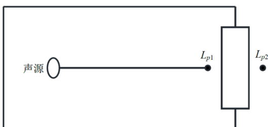
图 4-2 室内声源等效为室外声源图例
