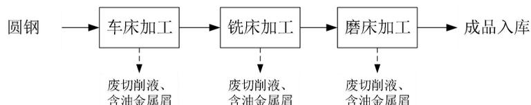
图 2-3 泵连接轴生产工艺流程图
