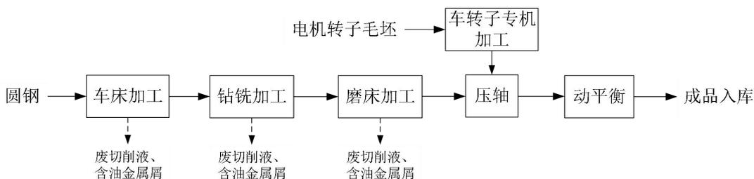
图 2-2 电机转子生产工艺流程图
