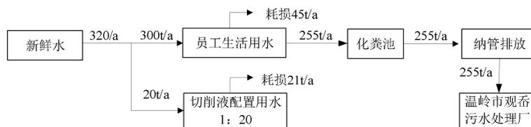
图 2-1 项目水平衡图
