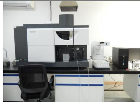
电感耦合等离子原子发射光谱仪
