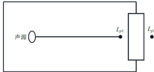
图 4-2 室内声源等效为室外声源图例
